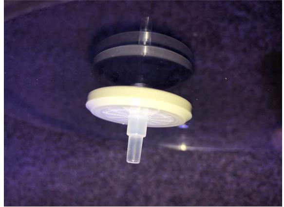
9. Beim Plexiglasstab 5/3mm habe das Ende unter 45° zu gesägt und gereinigt. Am anderen Ende kommt dann ein Stück Luftschlauch 4/6mm mit einem erneuten Spritzfilter drauf.
