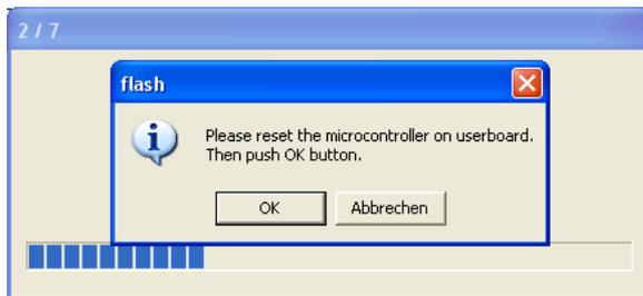
Jetzt die Reset-Taste drücken und solange halten, bis die Prog-LED aufleuchtet. Dann die Reset-Taste loslassen und die Lampe wechselt in den Programmiermodus.
