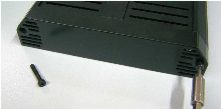
Drehen Sie die Lampe um und schieben die Schutzscheibe in Richtung der abgenommenen hinteren Abdeckung. Dabei den Deckel leicht nach oben anheben damit die Kunststoffniete nicht an Bauteilen (Kondensator) hängen bleibt.
